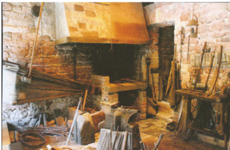
Une forge : l'âtre et la cheminée, le soufflet, l'enclume, l'étau, les outils.
